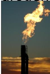
**Uscita - Gas:** Syngas (600-750 Btu). Utilizzato per la produzione di energia o utilizzati direttamente per scopi industriali.
